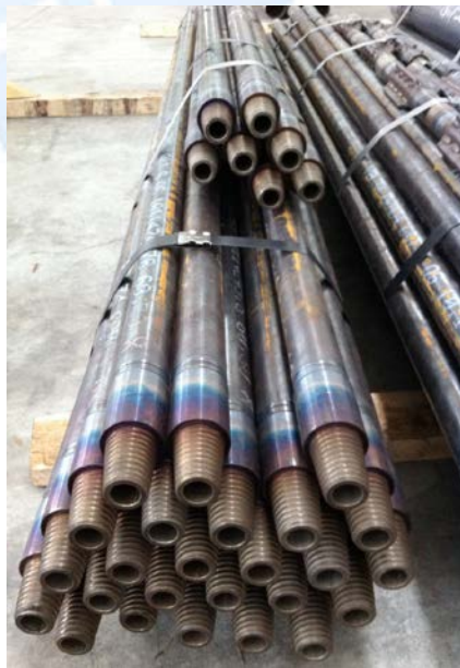
Reibgeschweisst 63,5 - NW Schaftrohr 60,3 x 7,1 mm
